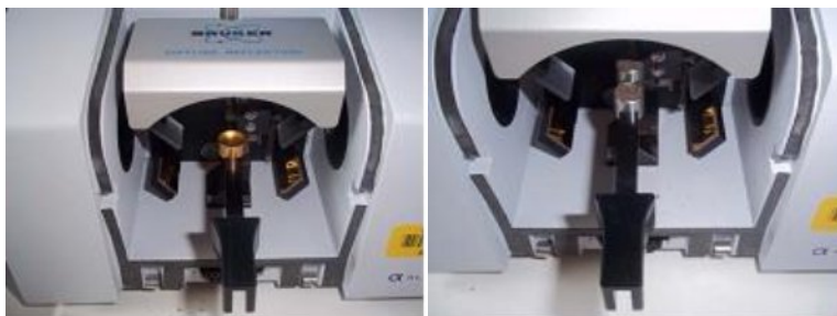
Ligante 2. Muestra HMA de campo (arriba a la izquierda), Preparación de la sonda DR (arriba a la derecha), muestra de referencia (abajo a la izquierda) y dos sondas DR (abajo a la derecha) en el compartimiento interior de espectrómetro DR .
